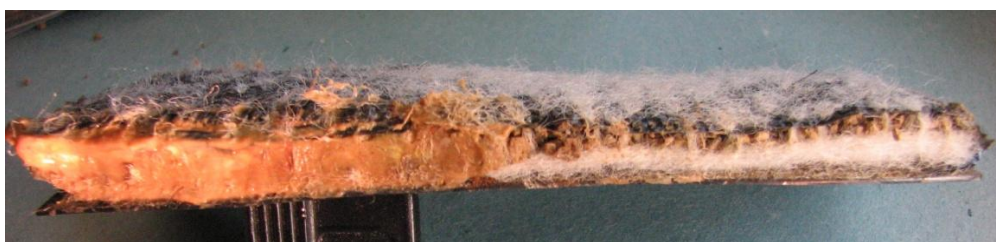
OBR.1 Pás s bentonitem složený m.j. ze dvou podélně vodopropustných vrstev(vlevo stav po nasáknutí vodou).
