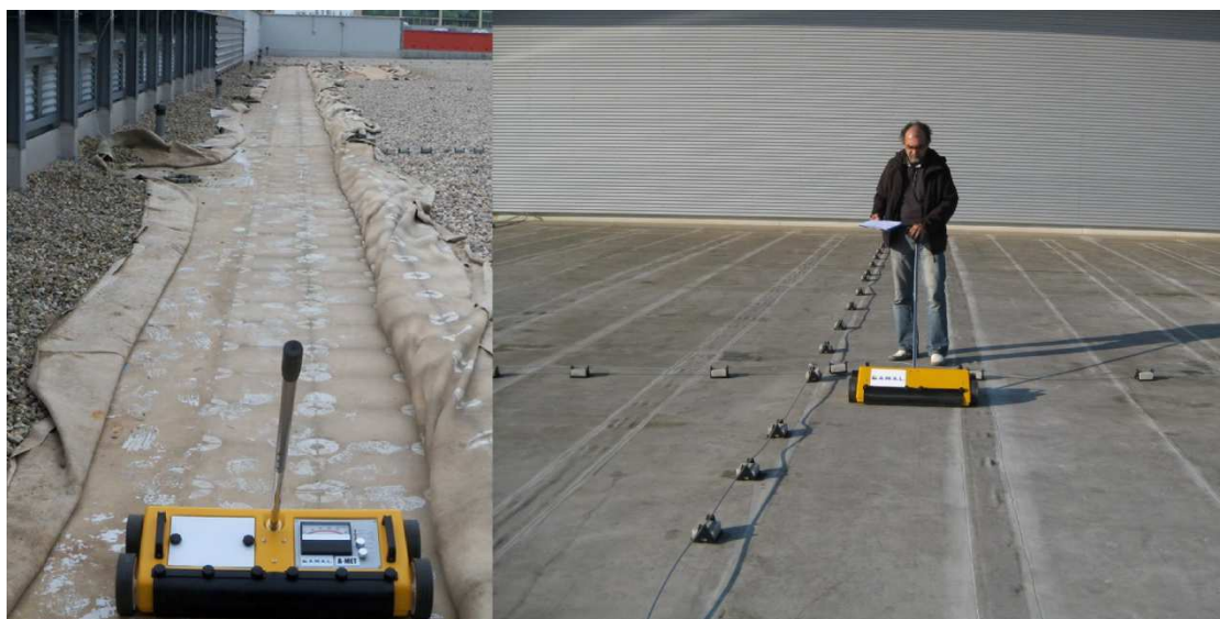
Obr. 4: Provádění impedanční defektoskopie in-situ
