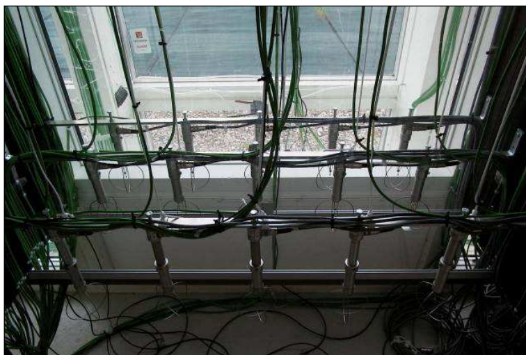
Obr. 3: 15 anemometrů u vstupu do dutin MK
